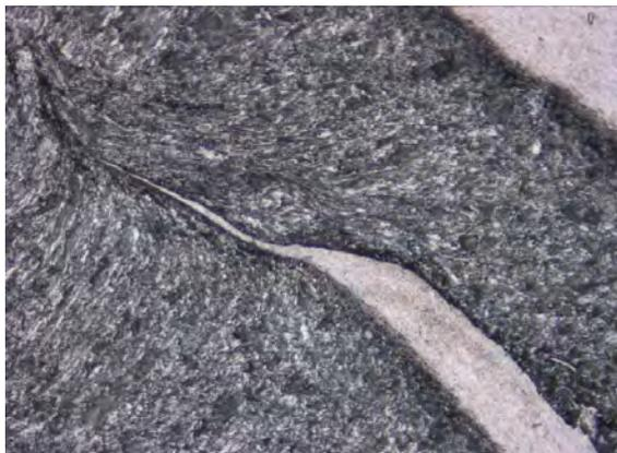
**Рис. 4.** Оптическая микрофотография участка зоны 1, отраженный свет. Тэнитовый прожилок располагается по диагонали изображения, приурочен к полосе сдвига и выклинивается вверх слева. Протравлено в нитале, ширина кадра 0,22 мм.
