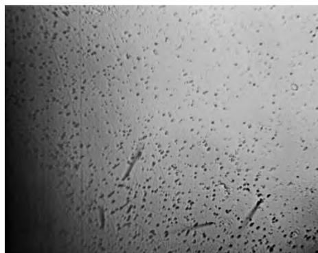
**Рис. 4.** Фрагмент микрофотографии поверхности кристалла оливина (палласит Marjalahti) с высоким градиентом плотности треков. Размер изображения 284×226 мкм.
