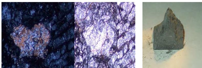
**Фото 1.** Зона ударной перекристаллизации. Шлиф метеорита Царев после разрушения при сжатии (разрез по высоте конического обломка перпендикулярно основанию образца).
